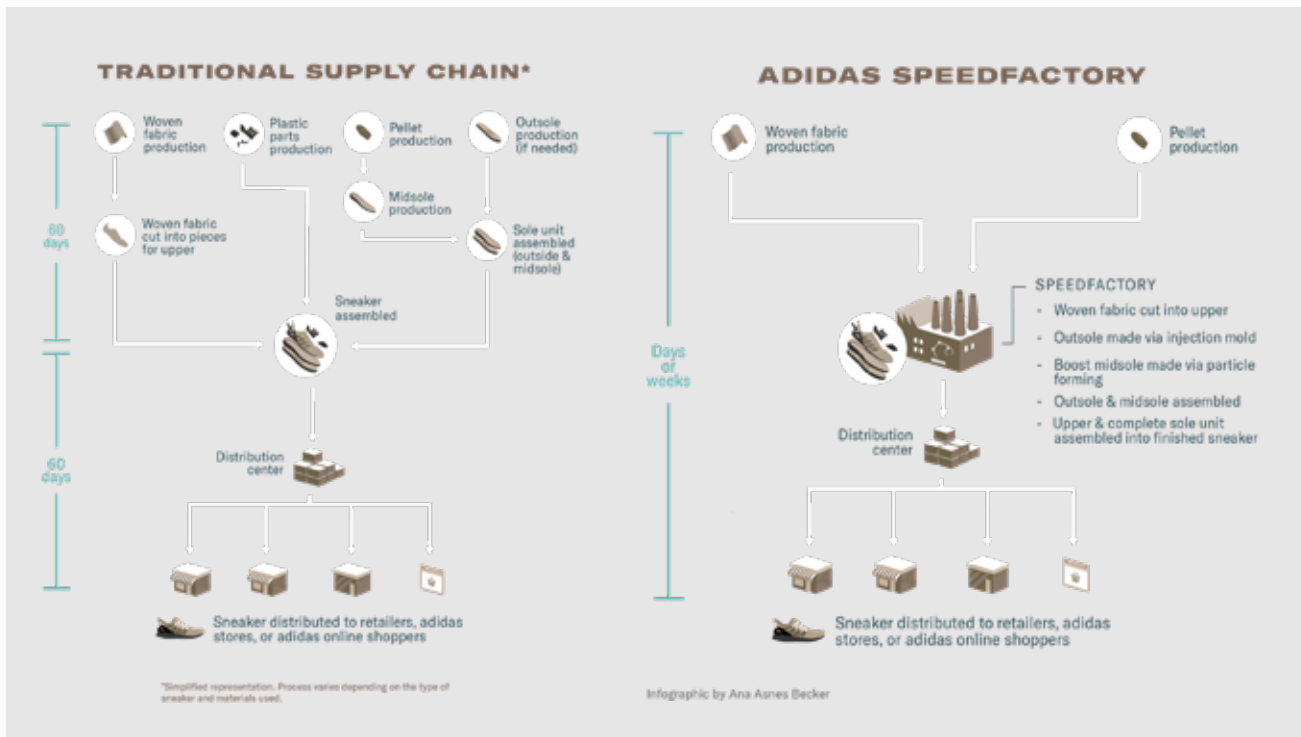
Figure 23. Schéma comparatif des chaînes d'approvisionnement traditionnelle et automatisée des chaussures d'Adidas Source : https://qz.com/se/perfect-company-2/1145012/a-german-company-built-a-speedfactory-to-produce-sneakers-in-the-mostefficient-way
